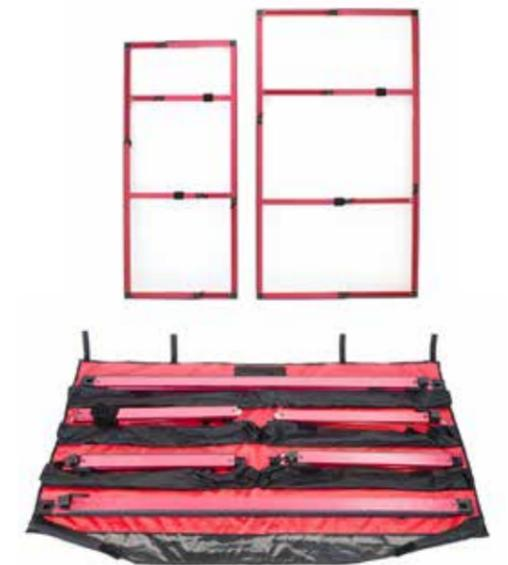
Estructura de aluminio de Blower Door. Fuente: Retrotec.
